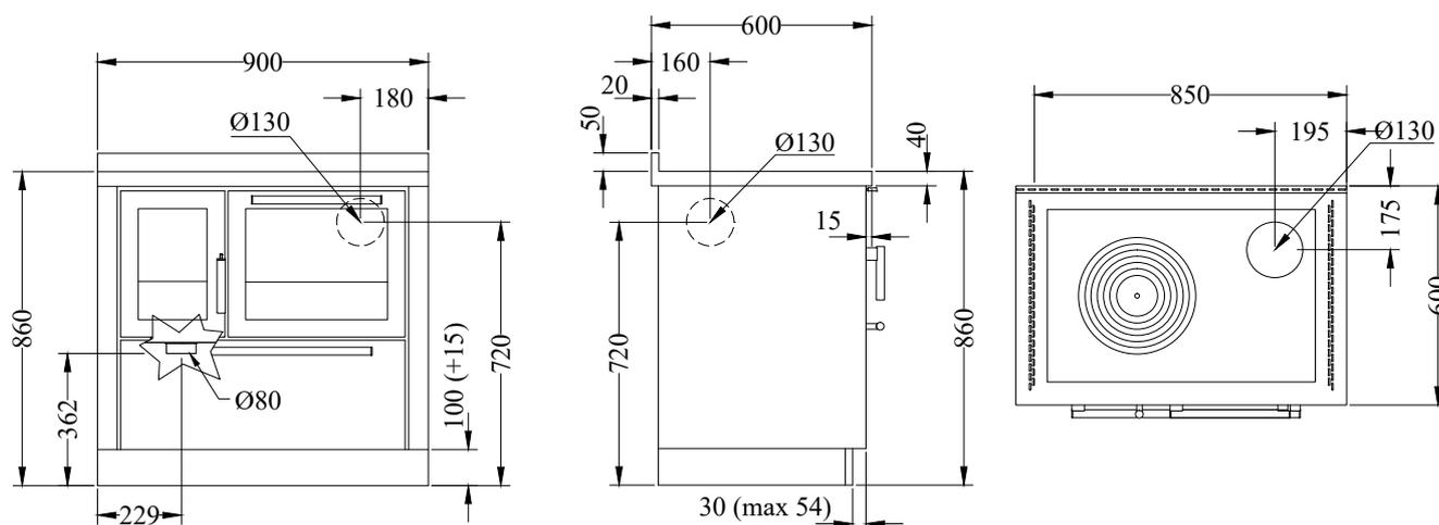
Versione con uscita fumi a destra. La versione con uscita fumi a sinistra è simmetrica.
